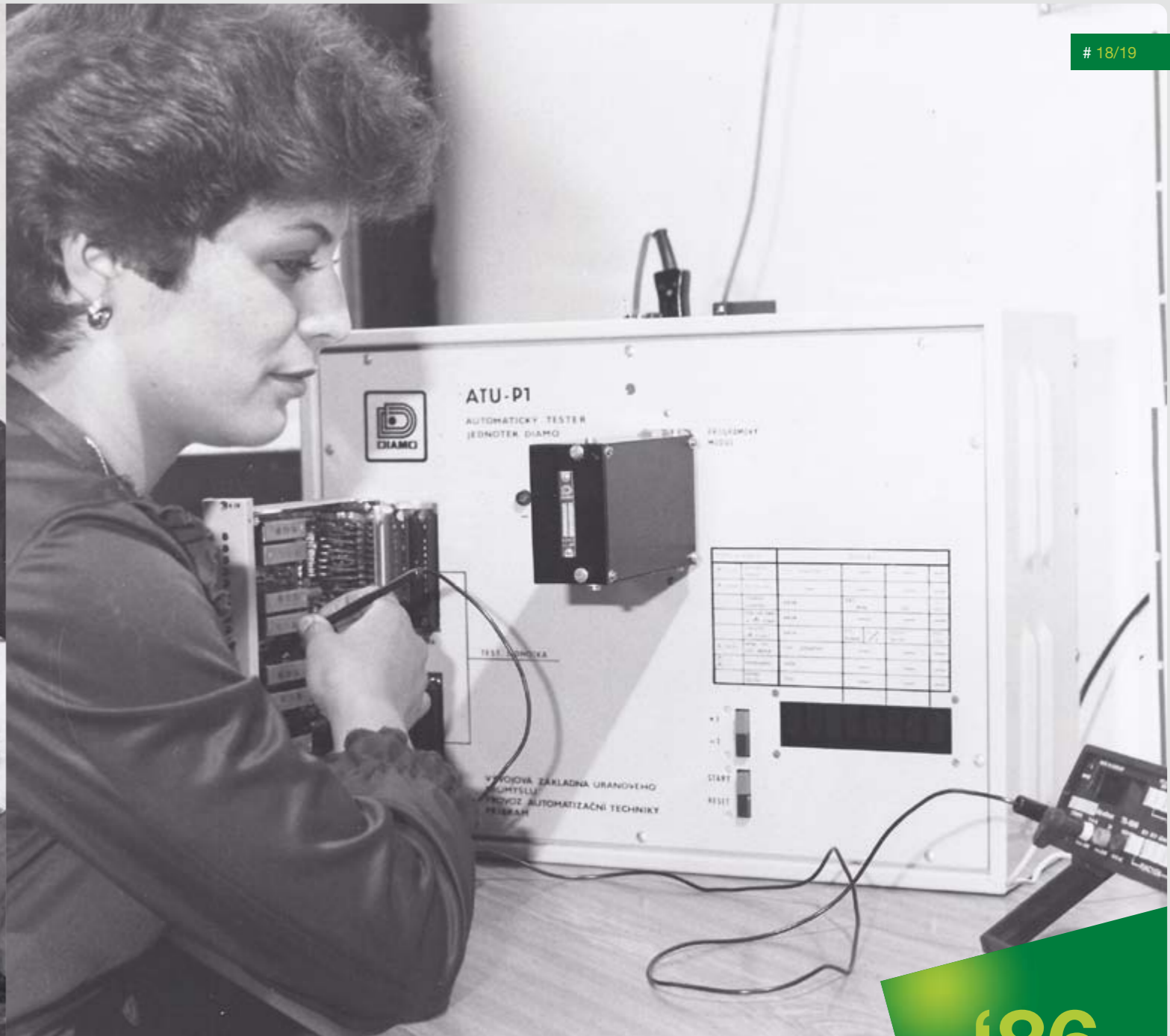
1986 – Zkoušení jednotek na testeru ATU-P1
